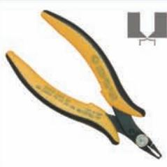
**TR 20 VM:** Utensile dal taglio raso frontale. Le ridotte dimensioni e l'inclinazione a 60° permettono di lavorare facilmente in spazi poco accessibili in elettronica. Spessore 2.0 mm. Lunghezza utensile 132 mm. Disponibile anche nella versione dissipativa.
