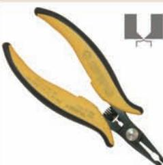
**TR 5000 V:** Utensile dal taglio raso frontale inclinato a 60° permette di lavorare in punti difficilmente accessibili. Simile al TR 30 V con spessore 5mm. Lunghezza utensile 147 mm. Disponibile anche nella versione dissipativa.
