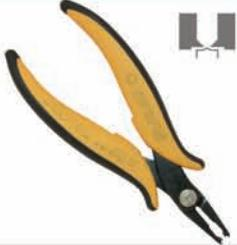
**TR 30 15 V:** Utensile dal taglio frontale inclinato a 60°. Appositamente studiato per il taglio del componente a mm 1.5 dal piano. Spessore 3 mm. Lunghezza utensile 144 mm. Disponibile anche nella versione dissipativa.
