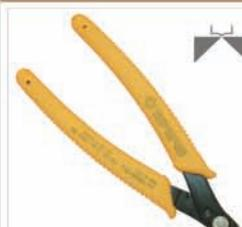
**TR 25 15 L:** Utensile dal taglio rovesciato. Sporgenza del terminale tagliato dal piano mm 1.5. Presenta le stesse caratteristiche del TR 25 15 ma è appositamente studiato con l'impugnatura più lunga per rendere meno pesante lo sforzo dell'operatore. Spessore 2,5 mm. Lunghezza utensile 160 mm. Disponibile anche nella versione dissipativa.
