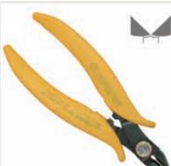
**TRR 58 B:** Utensile robusto con taglio raso. La superficie bombata dei taglienti permette un taglio con finitura. Spessore 3 mm. Lunghezza utensile 160 mm. Disponibile anche nella versione dissipativa.
