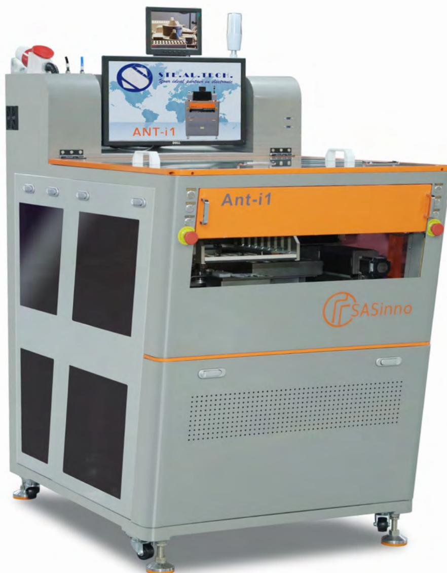
La saldatrice selettiva Ant-i1 è una macchina Entry-level utilizzata per la saldatura selettiva dei componenti THT montati sulle schede SMD a doppia faccia. L'ingombro ridotto e la compattezza della macchina fanno sì che possa essere installata anche in am-
