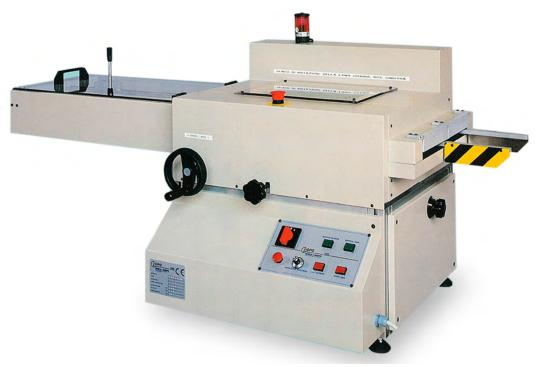
Questa macchina è stata progettata e costruita per eseguire l'operazione di rasatura, nel lato inferiore delle schede dei circuiti stampati, dopo la saldatura dei componenti. L'avvicinamento delle schede al tunnel di inserimento, avviene in modo manuale fino all'interno della macchina e successivamente procede in modo automatico.
