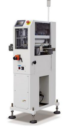
Il modulo di pulizia pcb pulisce e rimuove l'elettricità statica ed eventuale polvere dalle schede elettroniche nella linea SMT. I pcb vengono trasportati tramite un doppio nastro trasportatore con regolazione della velocità. Il modulo di pulizia è standard con una spazzola esd, vuoto o ionizzatore ad alta tensione.
