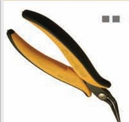
**PNB 2006:** Pinza lunga con becchi a punta lisci, particolarmente adatta per la presa di componenti in punti poco accessibili e per lavori delicati in elettronica. Becchi piegati a 45°. Spessore 3 mm. Disponibile anche nella versione dissipativa.
