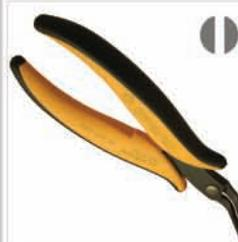
**PNB 2018:** Pinza con becchi piatti lunghi lisci, arrotondati esternamente per permettere la presa di componenti in punti ad alta intensità senza danneggiarli. Becchi piegati a 45°. Spessore 3 mm. Disponibile anche nella versione dissipativa.
