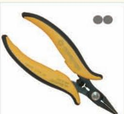
**PN 5025/1:** Pinza con becchi arrotondati lisci corti che permette la presa di componenti in zone affollate senza danneggiarli. Diametro punta 1.6 mm. Lunghezza punta 20 mm. Spessore 5 mm. Disponibile anche nella versione dissipativa.
