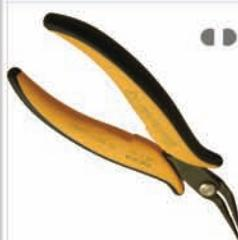
**PNB 2016:** Pinza con becchi a punta lunghi lisci, arrotondati esternamente per permettere la presa di componenti in punti ad alta intensità senza danneggiarli. Becchi piegati a 45°. Spessore 3 mm. Disponibile anche nella versione dissipativa.
