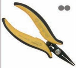
**PN 5025/2:** Pinza con becchi arrotondati lisci lunghi che permette la presa di componenti in zone affollate senza danneggiarli. Diametro punta 1.0 mm. Lunghezza punte 26 mm. Spessore 5 mm. Disponibile anche nella versione dissipativa.
