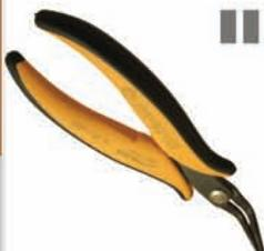
**PNB 2008:** Pinza lunga con becchi piatti lisci, particolarmente adatta per la presa di componenti in punti poco accessibili e per lavori delicati in elettronica. Becchi piegati a 45°. Spessore 3 mm. Disponibile anche nella versione dissipativa.
