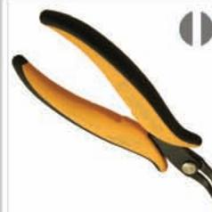
**PNB 2017:** Pinza con becchi piatti lunghi zigrinati, arrotondati esternamente per permettere la presa di componenti in punti ad alta intensità senza danneggiarli. Becchi piegati a 45°. Spessore 3 mm. Disponibile anche nella versione dissipativa.
