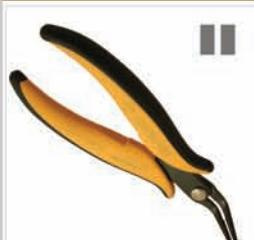
**PNB 2007:** Pinza lunga con becchi piatti zigrinati, particolarmente adatta per la presa di componenti in punti poco accessibili e per lavori delicati in elettronica. Becchi piegati a 45°. Spessore 3 mm. Disponibile anche nella versione dissipativa.
