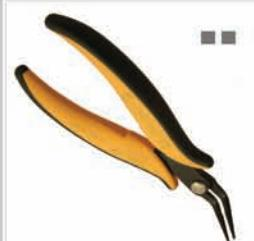
**PNB 2005:** Pinza lunga con becchi a punta zigrinati, particolarmente adatta per la presa di componenti in punti poco accessibili e per lavori delicati in elettronica. Becchi piegati a 45°. Spessore 3 mm. Disponibile anche nella versione dissipativa.
