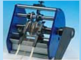
Il modello TP6/V/21-EC è utilizzato per tagliare e piegare i componenti assiali nastrati per montaggio in verticale. Lavora componenti con  $\varnothing$  del reoforo da 0,8 a 1,3 mm. Il passo di piegatura, determinato dalla camme fornita, può essere variato sostituendo la camme con una avente larghezza diversa.
