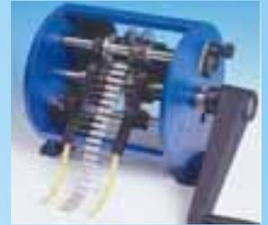
LUNGHEZZA TAGLIO "B" MINIMO 4,6 MM E DIAMETRO "d" MAX 0.8 MM
