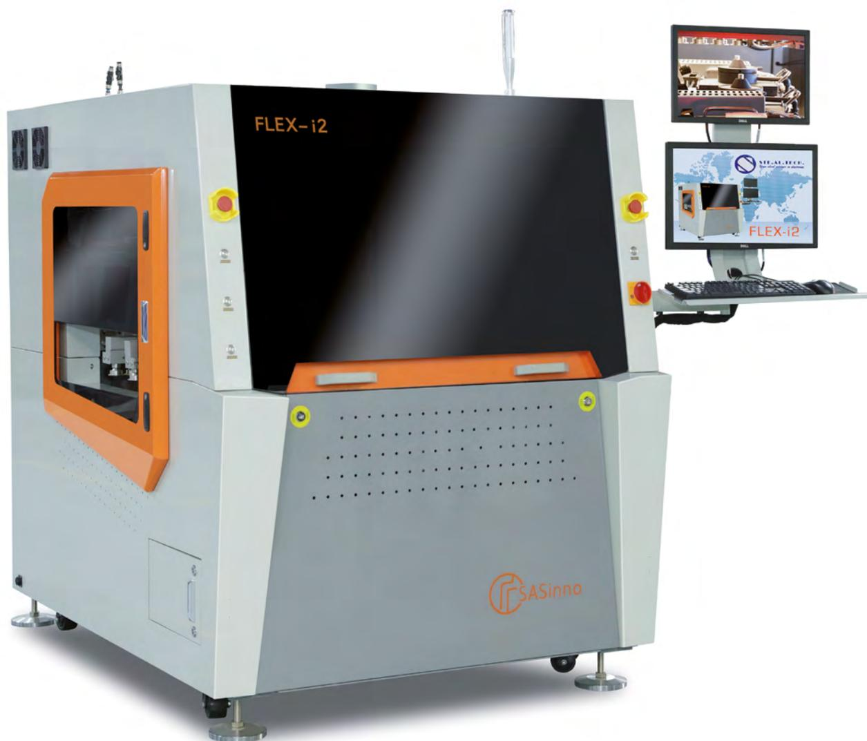
Flex-i1 è una saldatrice selettiva in linea. È una macchina compatta e flessibile, due caratteristiche importanti per la scelta di una selettiva. Flex-i1 è compatta perchè la piattaforma della saldatura e della flussatura sono un'unica struttura ed il preriscaldamento si colloca esattamente sopra la stessa piattaforma. Flessibile perchè la macchina può essere configurata con il doppio pozzetto (Flex-i2) e il doppio sistema di flussatura, il che significa poter utilizzare due ugelli
