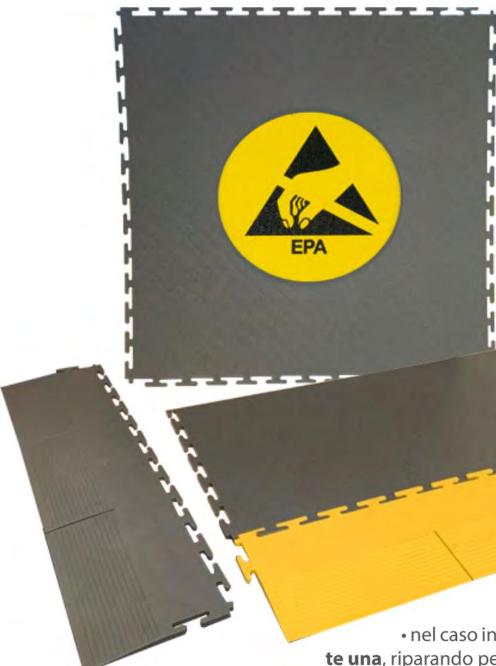
Queste **piastrelle ad incastro per pavimento** sono realizzate in **PVC** e durante il processo di stampaggio vengono **iniettate particelle di metallo**. In questo modo si genera un **effetto conduttivo omogeneo e durevole per l'intera vita del prodotto** (tenendolo comunque correttamente mantenuto mediante pulizia con detergente antistatico).
