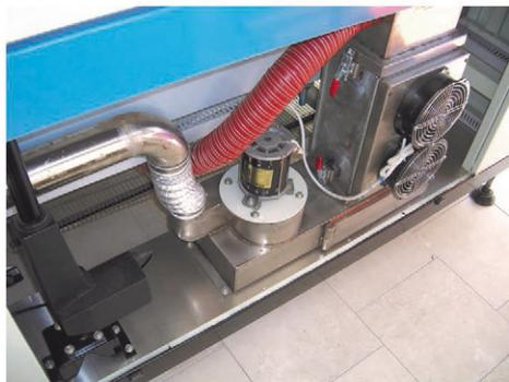
Il sistema di emissione all'esterno dell'aria esausta, è dotato di un **doppio filtro**, composto da uno **scambiatore di calore a serpentina (aria/aria)** e da un **panno in fibra di vetro**, che filtrano perfettamente le particelle di flussante residuo cristallizzato, mantenendo puliti, il tunnel di riscaldamento, le bocchette di uscita fumi e l'ingresso e l'uscita del tunnel, assicurando una lunga vita della macchina.
