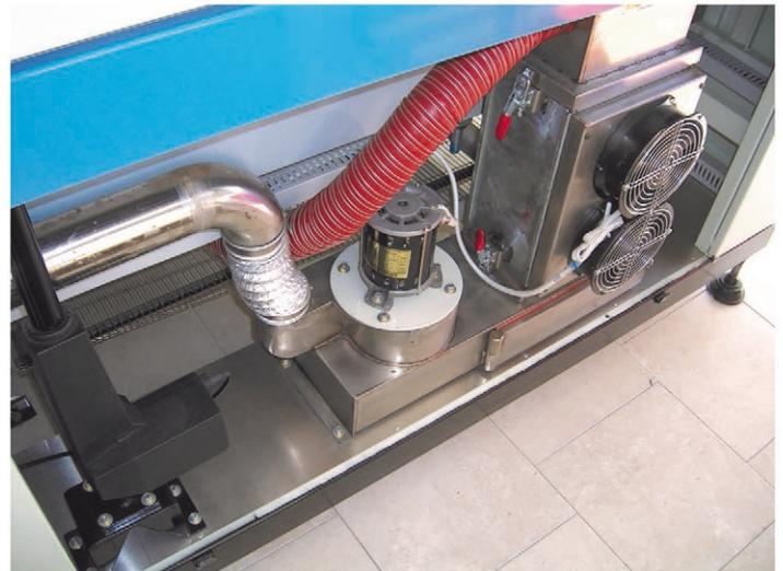
Le due ventole poste sul lato superiore dei due coperchi, hanno una portata AUTONOMA di circa 1800 metri cubi ora, estraggono la quantità d'aria corretta all'esterno del forno assicurando l'efficienza del riscaldamento interno con la **minima dispersione termica**.
