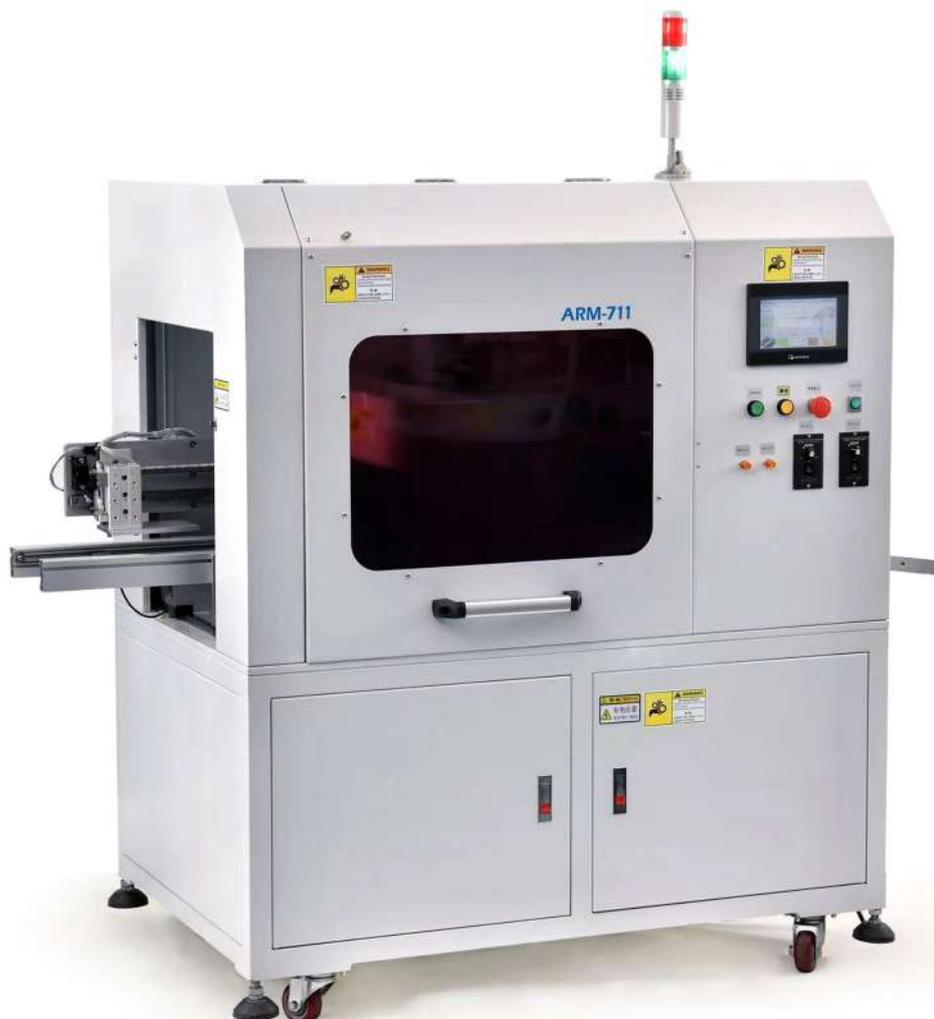
La macchina automatica per separare le schede elettroniche con lo scoring modello ARM-711 è la scelta perfetta per le aziende che desiderano automatizzare il processo di separazione dei pcb.
