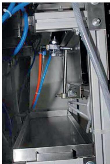
Il sistema di flussaggio utilizza lo **spray automatico**, che permette di dosare la quantità corretta di flussante spruzzato sul pcb. L'area ed il tempo di spruzzo, si regolano automaticamente in base alla dimensione del PCB. La movimentazione dell'ugello è controllata da **stepper motor**, una **cappa con un doppio filtro** è posizionata sopra l'unità di flussatura per prevenire la contaminazione esterna. La **pulizia automatica dell'ugello** mantiene costante le prestazioni dello spray.
