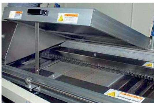
Il **coperchio superiore** mantiene il calore all'interno del tunnel di preriscaldamento ottimizzando i consumi elettrici.
