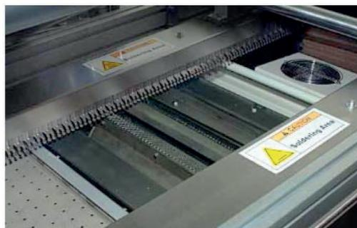
Il **pozzetto** è realizzato in **titanio**, è dotato di **doppia onda**, una turbolenta per la saldatura dei componenti SMD montati sul lato bottom della scheda, ed una **Main Wave** bidirezionale per la saldatura dei
