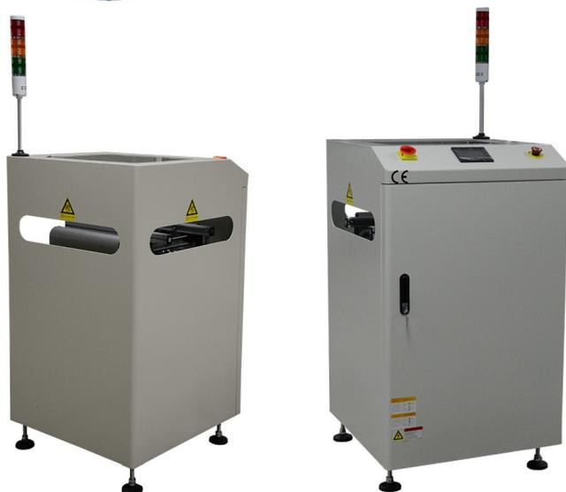
Il rotatore a 90 ° è utilizzato per cambiare la direzione del PCB di 90° all'interno di una linea automatica.
