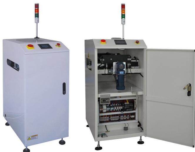
Il ribaltatore a 180 ° si colloca in una linea automatica (per esempio AUTO MOTIVE) per ruotare il pcb di 180° (Top & Bottom) per continuare il processo di assemblaggio del lato B del PCB.
