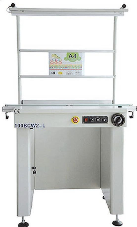
Il convogliatore 100BXW2L è il sistema di connessione automatica fra le varie attrezzature presenti all'interno di linee per l'assemblaggio di schede elettroniche automatiche, ideale per la finitura di schede elettroniche.
