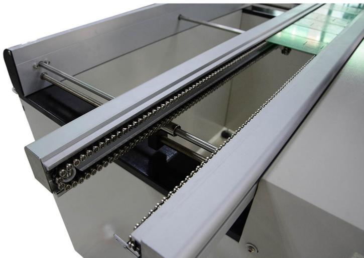
Il convogliatore ad accumulo della serie ER si utilizza come buffer per accumulare le schede ALLA FINE di una linea di assemblaggio, come un forno, una A.O.I o un conformal coating.
