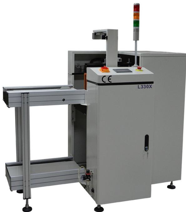
Il primo COMBINATO CARICO/DESTACKER che unisce il sistema di carico automatico dei PCB con prelievo direttamente dal rack, con il carico pcb direttamente dal pacchetto, con ventose.
