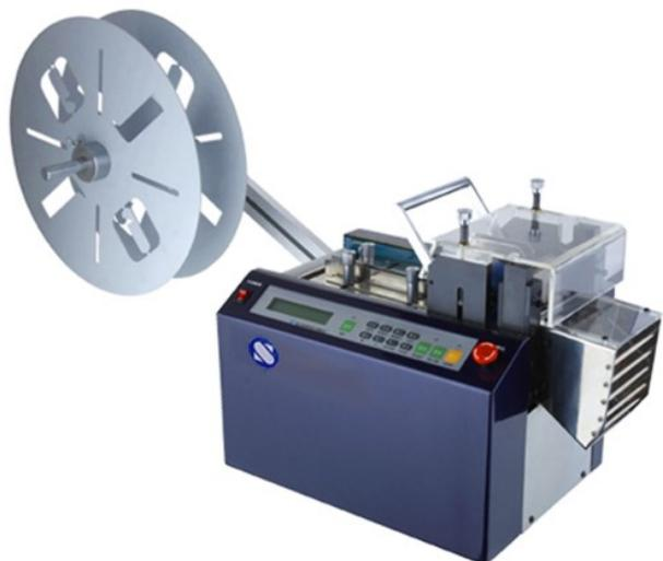
La spezzonatrice SPZ1 è impiegata per il taglio dei conduttori unipolari, tubetti di plastica, guaine, flat cable ecc.
